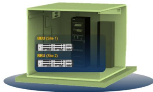
© 基于 C-RAN 架构的 NR2.6G + 700M 极简叠加的规划方案，通过 BBU 融合方式，实现多站合框单站点网络能耗降低 2.4 千瓦时 / 天
