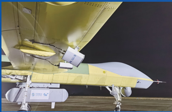
翼龙“高空基站”为灾区通信护航
